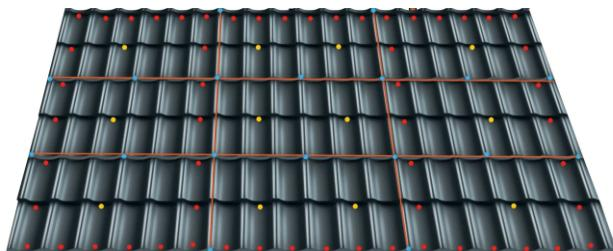
Skardai tvirtinti reikėtų naudoti 4,8 x 35 mm cinkuotus sraigus su danga. Plokštėms jungti rekomenduojama naudoti sraigus TORX 4,8 x 25 mm. Nesvarbu, koks tvirtinimo būdas pasirenkamas, sraigus visada būtina sriegti pagal pateikiamą schemą.
